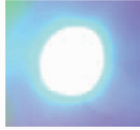
图 3 305 nm 激光光斑形状
