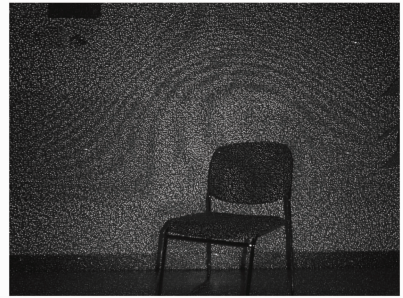
图 3 工作椅调制散斑图
