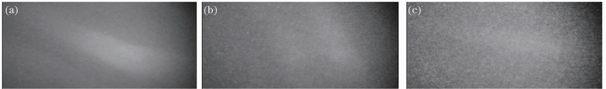
图7 距离选通主动照明实验。(a)目标深度 5 m; (b)目标深度 6 m; (c)目标深度 7 m
