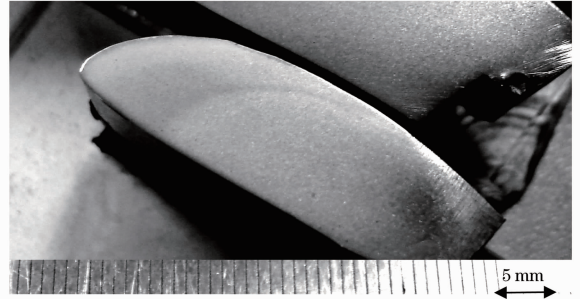
图 7 叶片头部硬化层的宏观照片
