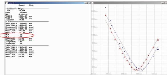
图 4 再生放大器输出激光光束质量
