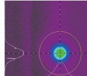
图 5 再生放大器输出激光光斑
