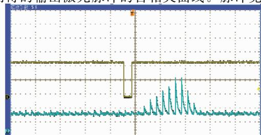
图 3 输出脉冲自相关曲线
