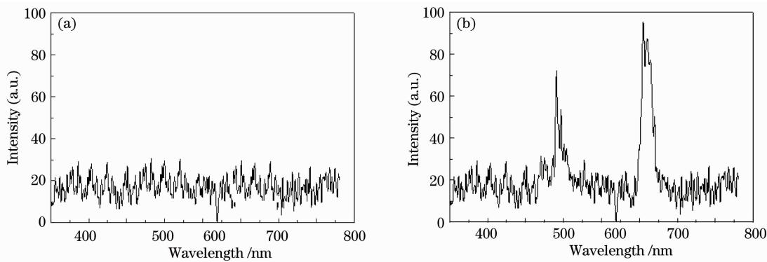
图 2 978 nm 激光辐射下受激发射光谱。(a) 假币上的光谱；(b) 真币上的光谱
