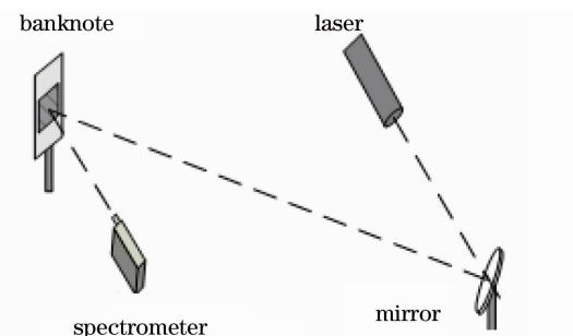
图1 纸币激光鉴别测量实验图
