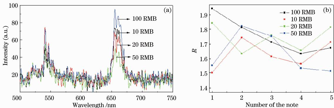
图 3 (a) 978 nm 激光辐照下不同币值纸币受激发射光谱及(b)不同币值归一化结果
