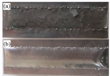
图 1 Ni 基 Wc/Cr 3 C 2 熔覆层宏观形貌。(a)脱渣前; (b)脱渣后
