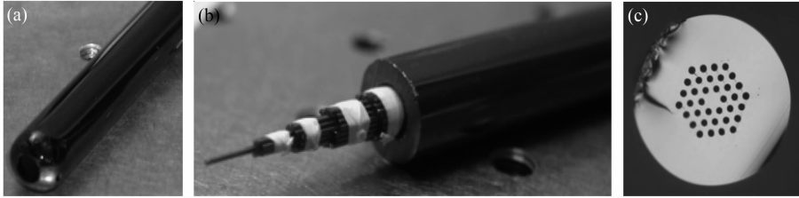
图 2 堆积法制备硫系 PCF 过程实物图。(a)旋转法获得的玻璃管;(b)毛细玻璃管组合成光纤预制棒;(c)拉制后的光纤端面图
