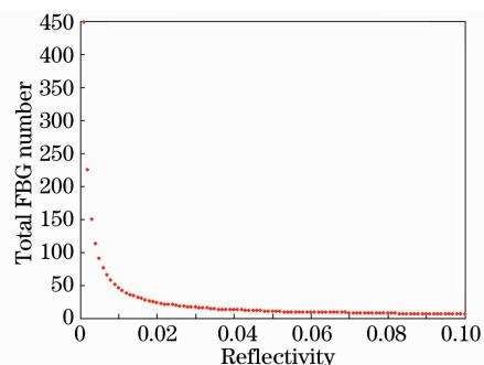
图 4 光纤光栅复用数与反射率的关系图
