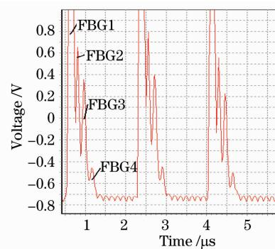
图7 脉冲光信号的时域波形
