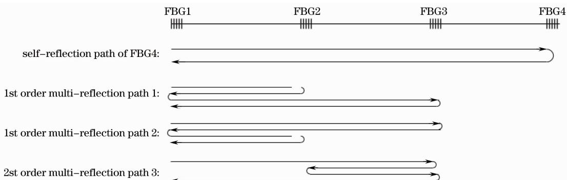
图 3 一级多反射路径示意图
