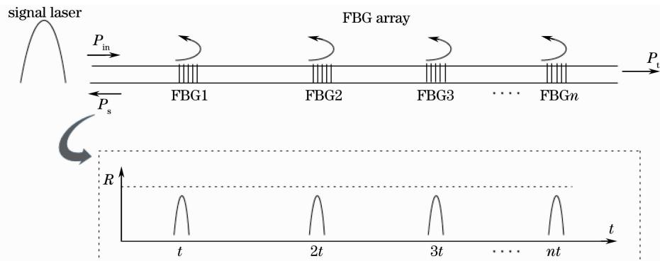
图 1 基于弱反射光栅光纤的分布式传感方法原理图
