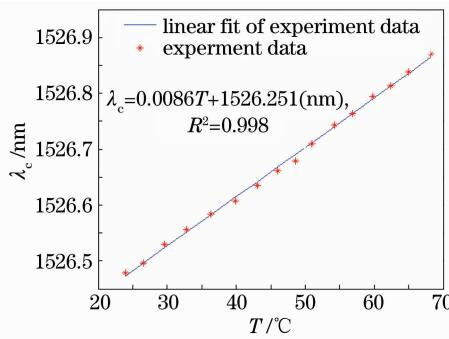
图 8 实验测量的 FBG1 中心波长和温度关系
