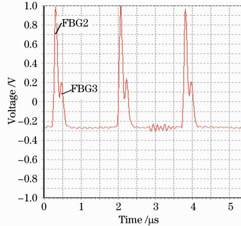
图 10 FBG2 和 FBG3 同温度测量的时域波形
