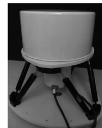
图 7 单轴旋转激光陀螺惯导系统 Fig. 7 LGINS with single-axis rotation
