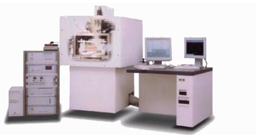
图 1 Raith 150 电子束直写系统
