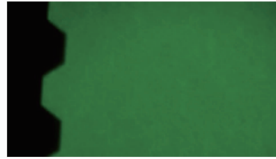
图 3 800 V 工作电压下小孔径实体边 MCP 的增益照片 Fig. 3 Gain photo of MCP with small channels at voltage of 800 V
