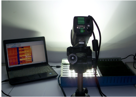
图 6 红外温度测试装置 Fig.6 Infrared temperature measurement setup
