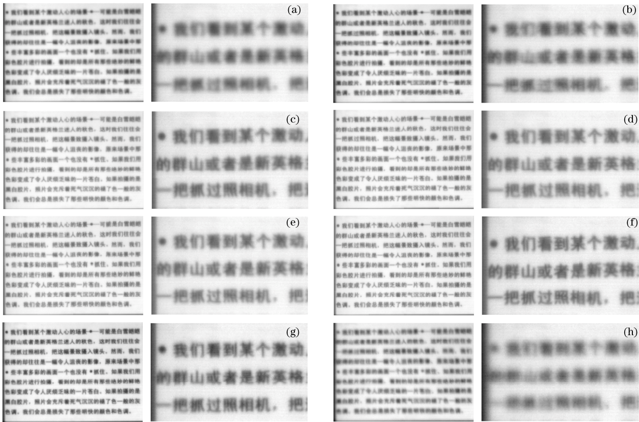
图 4 扩展目标幸运成像处理结果。(a)序列平均( 3.0909 \times 10^8 ); (b)100%全帧偏移叠加( 4.7139 \times 10^8 ); (c)0.5%幸运叠加( 1.4227 \times 10^9 ); (d)0.2%幸运叠加( 1.4983 \times 10^9 ); (e)0.1%幸运叠加( 1.6472 \times 10^9 ); (f)0.02%幸运叠加( 1.9388 \times 10^9 ); (g)原始图中最好的一帧( 1.4629 \times 10^9 ); (h)原始图中最差的一帧( 1.0199 \times 10^8 )
