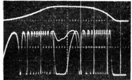
图 高压脉冲测量试验的波形图记录。上面的描述通过分压器得到,而下面的描述则是利用经克尔盒调制的偏振激光束得到的。测量了两个脉冲,峰振幅相差 1%。分压器描述是一根线,而克尔盒装置则明显地把这两个脉冲的差别分辨开来,情况如下描述中部所示。
