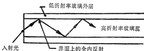
图2 光学纤维由高折射率玻璃中心芯和低折射率玻璃外层构成。
