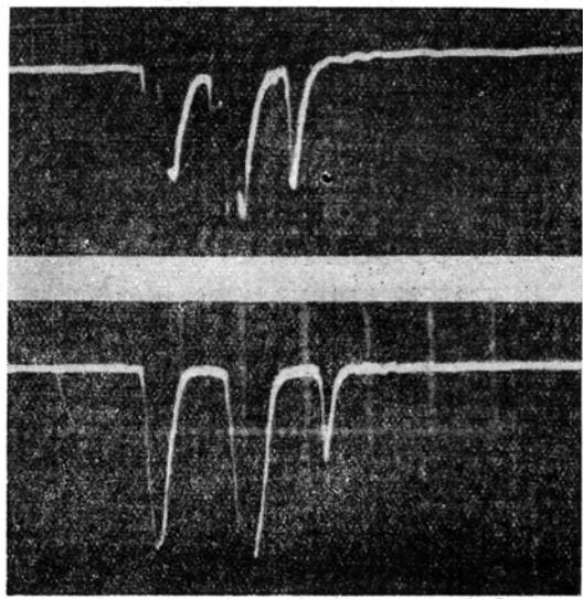
“光子回波”的产生；回波的方向与入射光束方向的关系略似于时间关系。在下面的示波图中，“回波”在右边；每一大格代表  $10^{-7}$  秒。
