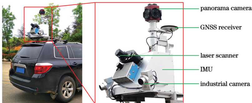
图 10 车载激光移动测量系统
