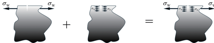
图 11 残余压应力抑制裂纹扩展 [105]
