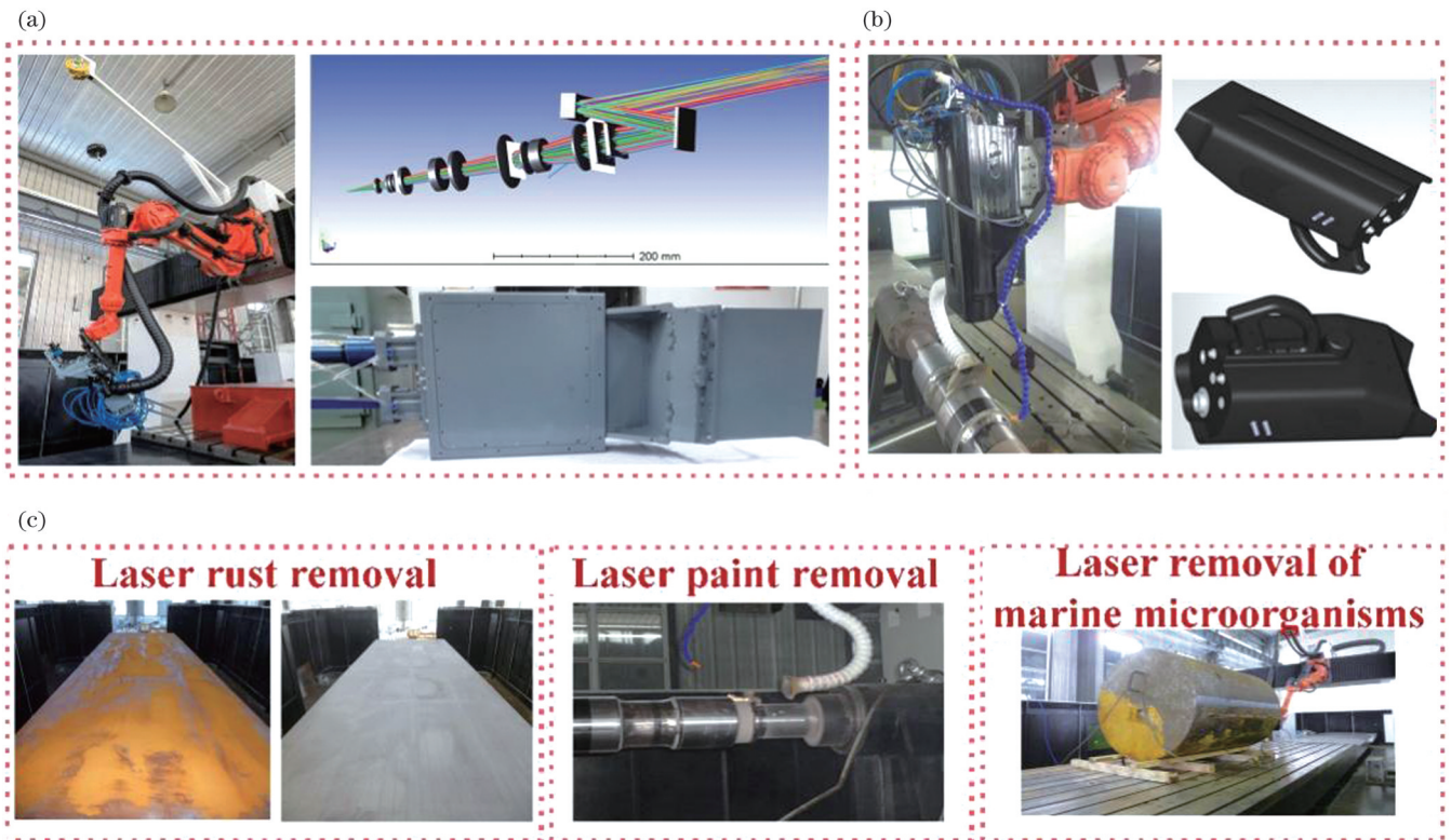
图 26 哈尔滨工业大学超长线光斑高效激光清洗装备 [61] 。(a)基于多光源复合光路的超长线光斑激光高效清洗头；(b)振镜扫描式超长线光斑激光高效清洗头；(c)面向高铁、海洋大型构件的激光高效清洗应用与装备验证
