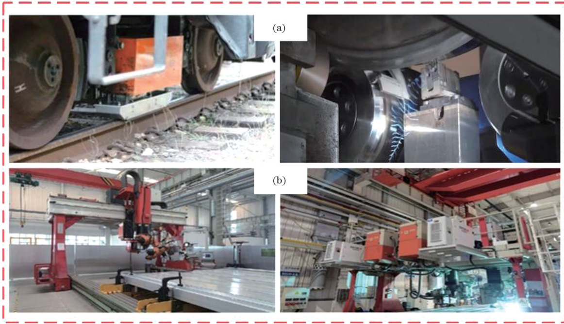
图 23 国内外轨道交通智能激光清洗装备 [59-60] 。(a)激光列车;(b)“清焊一体化”装备
