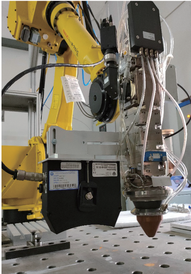
图 2 激光焊接缺陷检测实验系统
