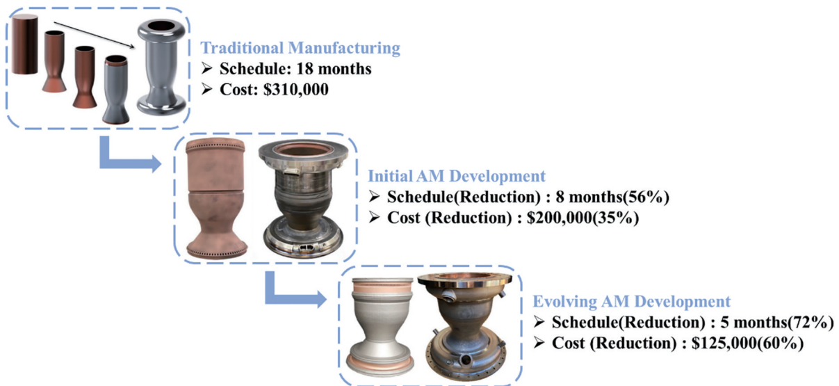
图 13 NASA 液体火箭发动机铜合金/高温合金双金属燃烧室制造工艺的发展及变革 [2,9,11-12]
