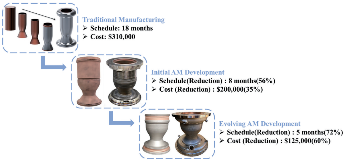
图 13 NASA 液体火箭发动机铜合金/高温合金双金属燃烧室制造工艺的发展及变革 [2,9,11-12]
