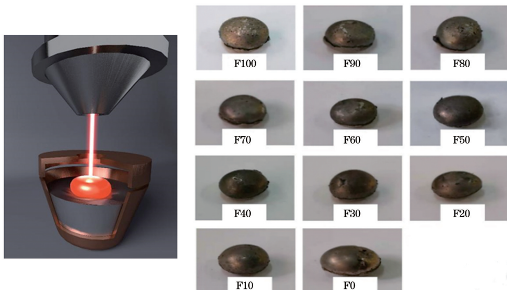
图 1 激光熔炼示意图以及合金锭试样实物图
