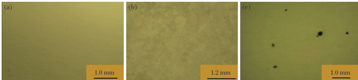
图 1 不同材料制备的试件的金相组织。(a) TC4 合金; (b) 316L 不锈钢; (c) B30 合金
