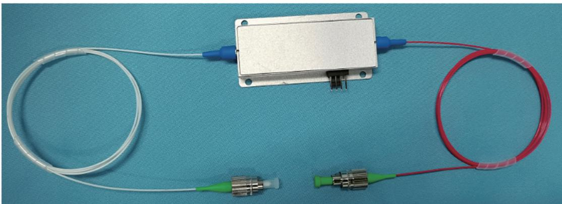
图 5 硅基 PPLN 薄膜脊形波导器件
