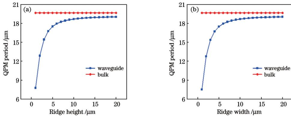
图 2 室温下基频光波长为 1560 nm 的 PPLN 的 QPM 周期与波导尺寸之间的关系。(a) QPM 周期与脊高之间的关系; (b) QPM 周期与脊宽之间的关系
