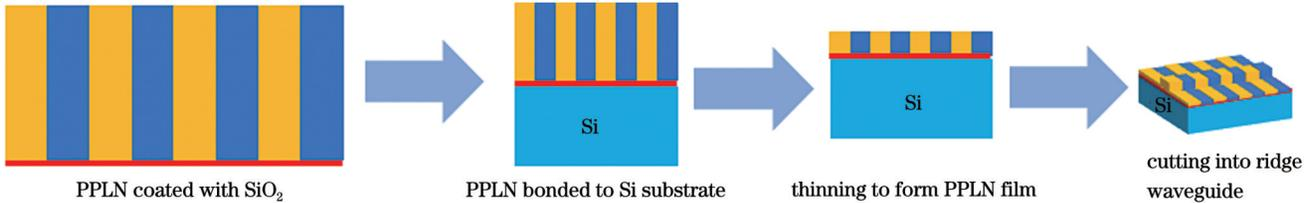
图 4 PPLN 脊形波导的制备过程
