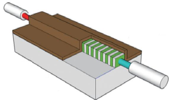
图 1 PPLN 脊形波导结构示意图
