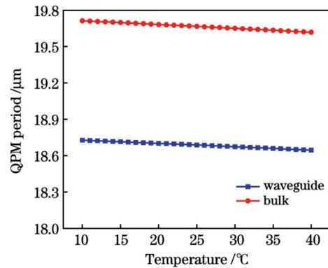
图 3 基频光波长为 1560 nm 及脊高和脊宽都为 10  $\mu\text{m}$  的 PPLN 的 QPM 周期与温度之间的关系
