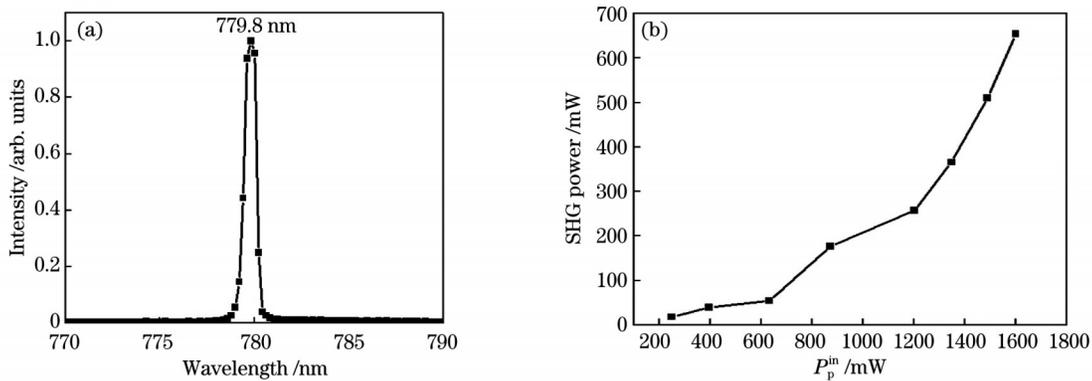
图 7 硅基 PPLN 薄膜脊形波导器件的测试结果。(a) 光纤进光纤出 PPLN 波导封装模块的输出光谱图；(b) PPLN 波导封装模块的输出功率与输入功率之间的关系
