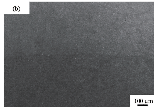
图 3 合金涂层的截面和结合区微观图。(a) 截面; (b) 结合区
