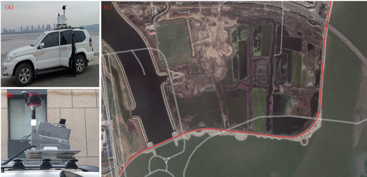
图 12 动平台成像实验。(a)实验搭载平台;(b)系统整体安装;(c)测试区域谷歌地图。
