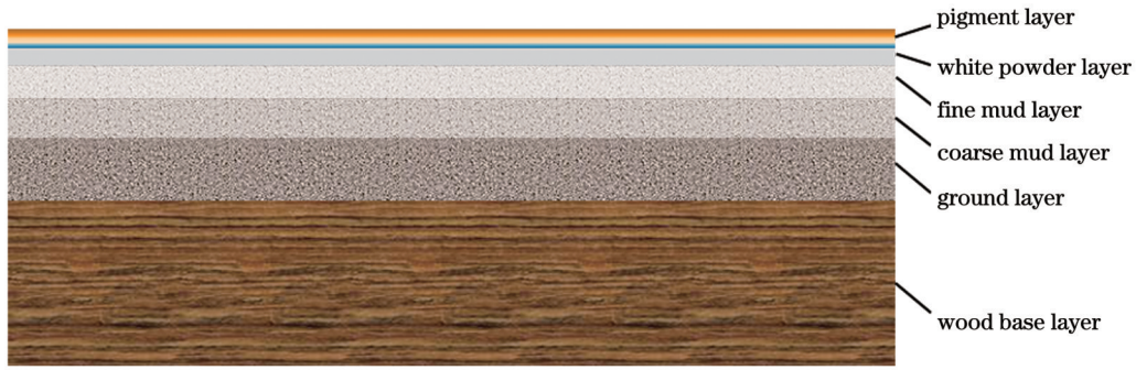
图 15 被测壁画的结构剖面示意图
