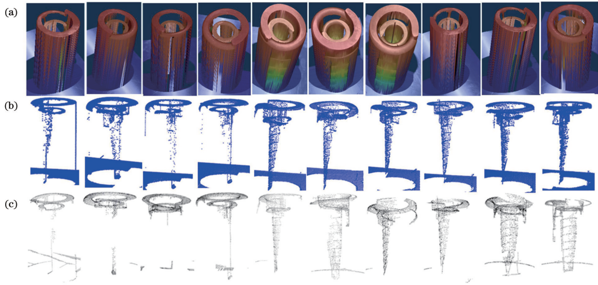
图 10 点云数据采集和预处理。(a)枕簧三维图像;(b)点云数据转换;(c)点云预处理
