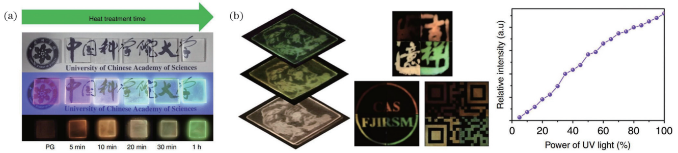
图 14 基于 \text{LiGa}_5\text{O}_8:\text{Mn}^{2+} 纳米晶的 5D 光存储 [59] 。(a) 玻璃结晶后 \text{Mn}^{2+} 位点变化引起多色发射；(b) 3D 空间/波长/强度复用的光存储演示实验
