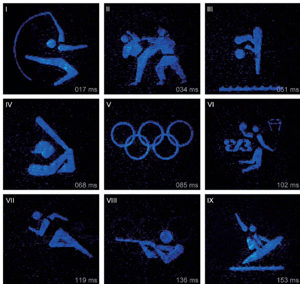
图5 基于铌酸锂晶体实现刷新频率为60 Hz的动态全息显示
