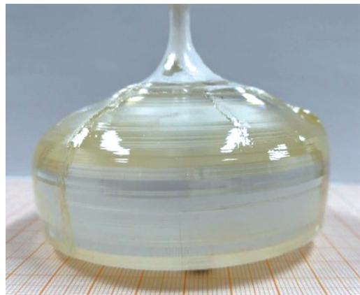
图 4 3 英寸的 SLN 晶体
