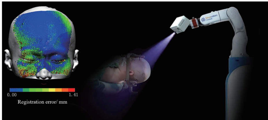
图 7 基于结构光的患者头皮形态感知
