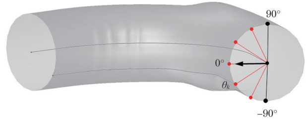
图 7 弯曲内侧面轮廓线的生成示意图
