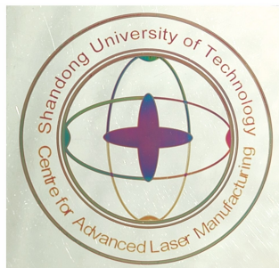
图 14 实际的激光着色图案
