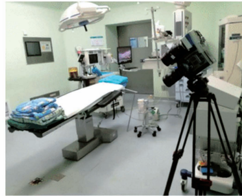
图 2 开放式 NIR-II 荧光手术导航系统 [33]
