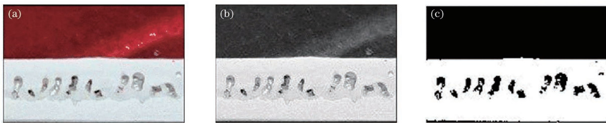
图 6 焊缝纵截面气孔提取流程。(a) 焊缝纵截面;(b) 灰度图像;(c) 阈值分割
