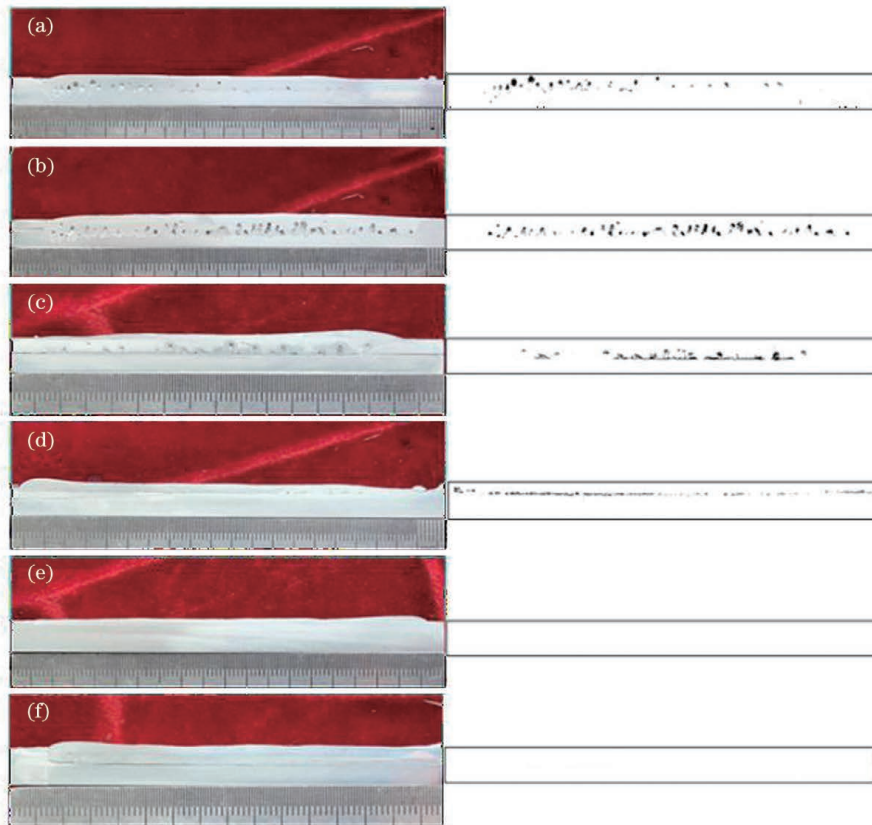
图 7 不同热源角度焊缝纵向截面形貌与二值化图像。(a) 试验 1, \alpha=82.5^\circ, \beta=120^\circ ; (b) 试验 2, \alpha=82.5^\circ, \beta=140^\circ ; (c) 试验 3, \alpha=70^\circ, \beta=140^\circ ; (d) 试验 4, \alpha=97.5^\circ, \beta=120^\circ ; (e) 试验 5, \alpha=97.5^\circ, \beta=140^\circ ; (f) 试验 6, \alpha=110^\circ, \beta=140^\circ
