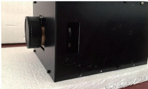
图 4 中红外偏振探测系统原理样机
