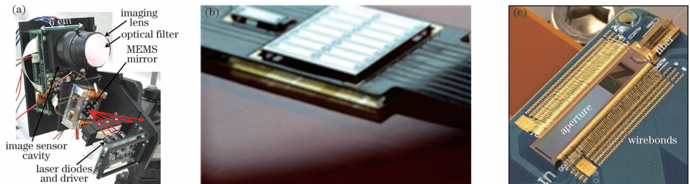
图 2 轻量型感知激光雷达扫描技术进展。(a)日本丰田中央研发实验室 MEMS 激光雷达 [12] ; (b)德国弗劳恩霍夫光子微系统研究所 23 mm 孔径 MEMS 振镜阵列 [15] ; (c)美国 Analog Photonics OPA 芯片 [16]
