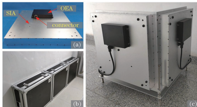
图 8 研制的样机。(a)DD-FORS 样机;(b)包装箱;(c)BHFORS-3C
