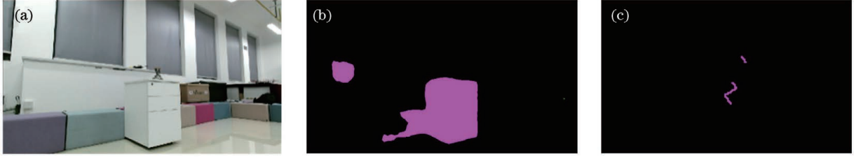
图 11 纯语义分割获取到的柜子语义。(a) 机器人视角;(b) 语义分割结果;(c) 点云坐标映射结果
