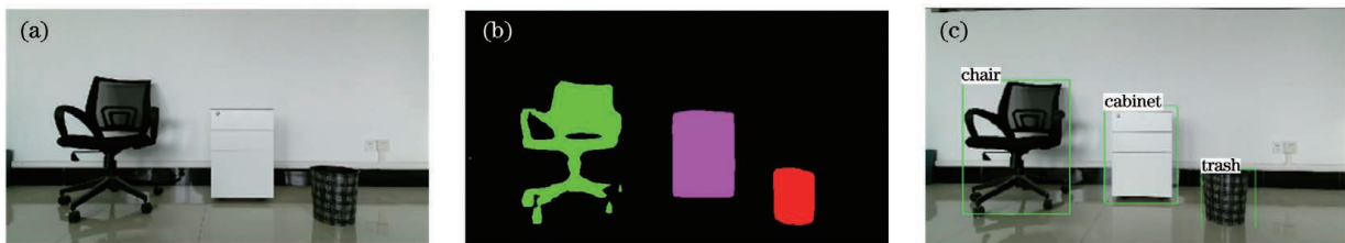
图 5 语义分割结果。(a)机器人视角;(b)语义分割;(c)目标检测
