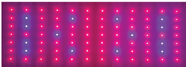
图 16 红光和蓝光 LED 均匀排列实物图
