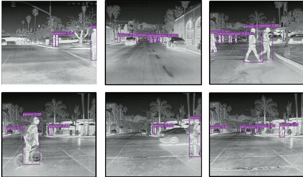
图 7 YOLO-Person 模型在 Jetson Nano 上的检测效果
