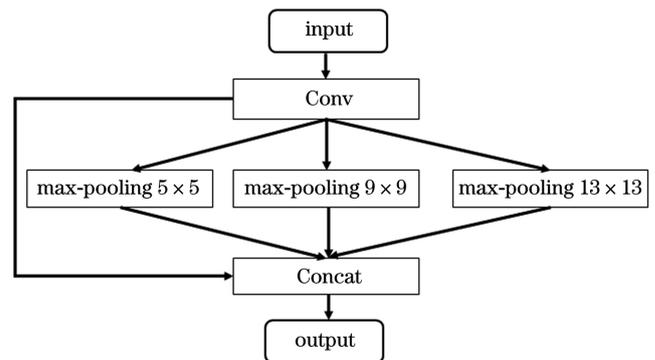
图 2 SPP 模块结构图
