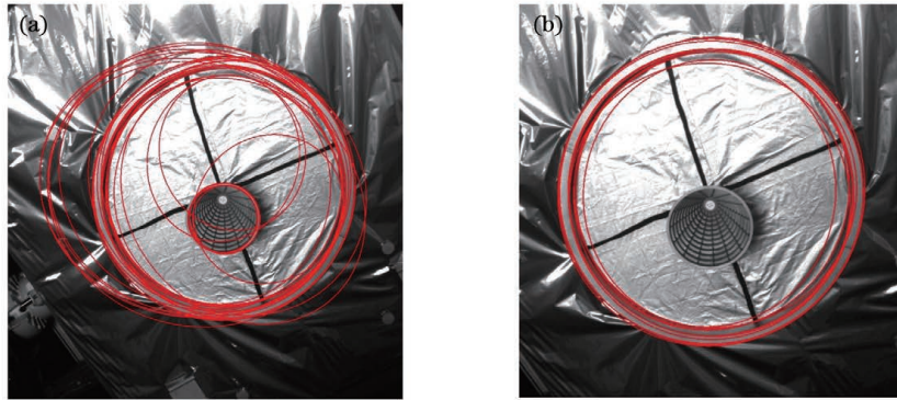
图 2 弧段两两组合候选椭圆结果图。(a)弧支持线段方法;(b)改进后的方法
