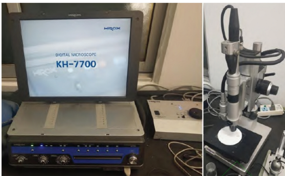
图 2 数字式三维视频显微镜 HIROX KH-7700
