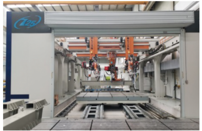
图 1 激光焊接系统
