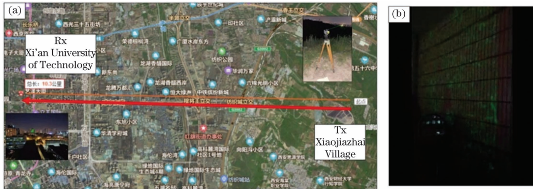
图 12 无线光通信系统 10.3 km 外场实验示意图。(a)链路图;(b)远场光斑
