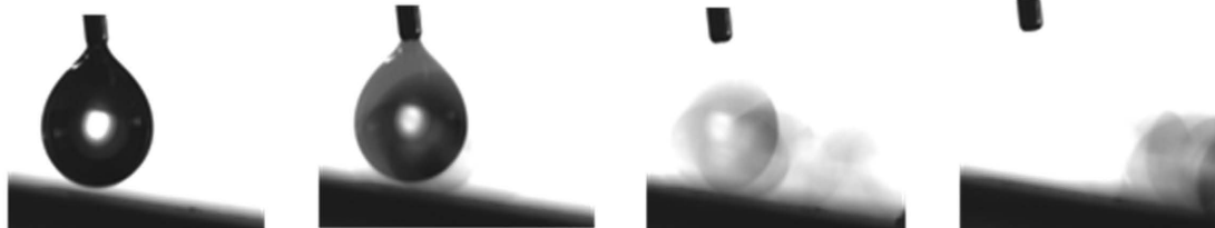
图 6 老化 700 h 后硅橡胶表面的斜坡滚动状态。(a)原始表面;(b) 5.0 \text{ J} \cdot \text{cm}^{-2} 能量密度激光刻蚀的硅橡胶样品表面
