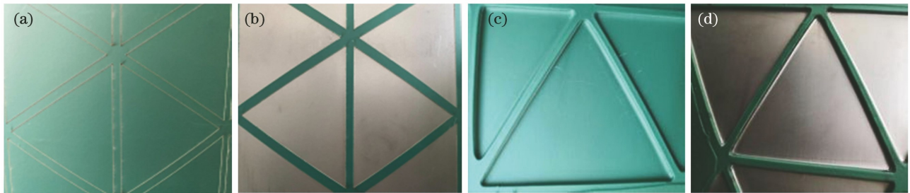
图 15 工程测试样件的激光刻型结果。(a)一次刻型;(b)一次揭胶;(c)二次刻型;(d)二次揭胶
