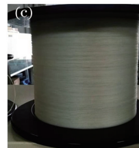
图 4 WFBG 水听器相位-声压灵敏度测试系统。(a) 系统; (b) 振动液柱; (c) 涂覆光纤
